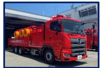
大型排水ポンプ車
