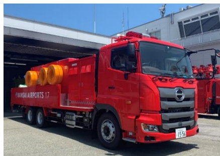
大型排水ポンプ車
