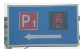
反射式表示板とLEDユニットを組み合わせた道路情報表示
