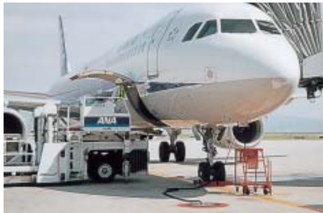
固定動力施設
